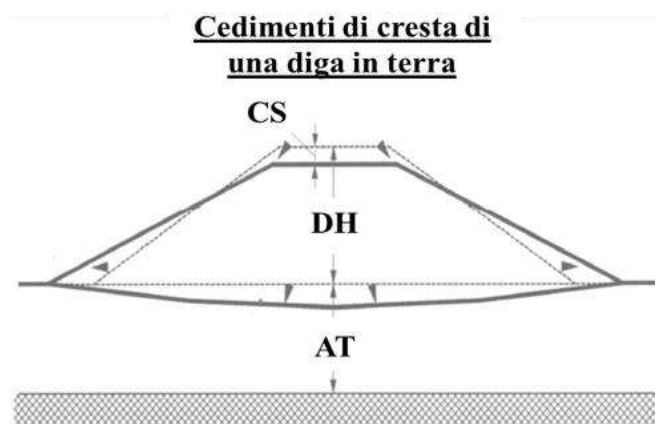
Figura 7 - Modello di danno adottato da Swaisgood (modificato da [2]).
